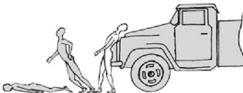
«Рис. 2.3» Фронтальное столкновение легкового автомобиля с пешеходом (столкновение с автомобилем; падение на автомобиль; падение на грунт и скольжение по нему) 2 .
