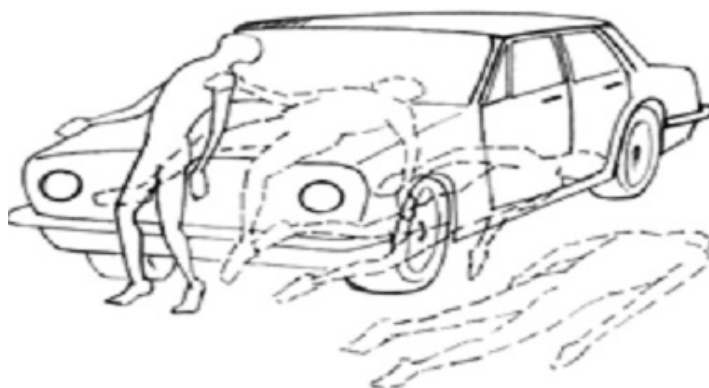
«Рис. 2.3» Фронтальное столкновение легкового автомобиля с пешеходом (столкновение с автомобилем; падение на автомобиль; падение на грунт и скольжение по нему) 2 .
